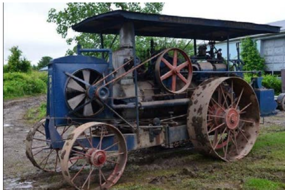
Tracteur à vapeur haute pression Baker 20-40
