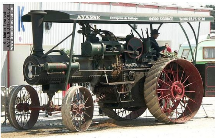
La CASE Locomotive 20 Ton - tracteur multi-usages, moteur à vapeur de 1898
