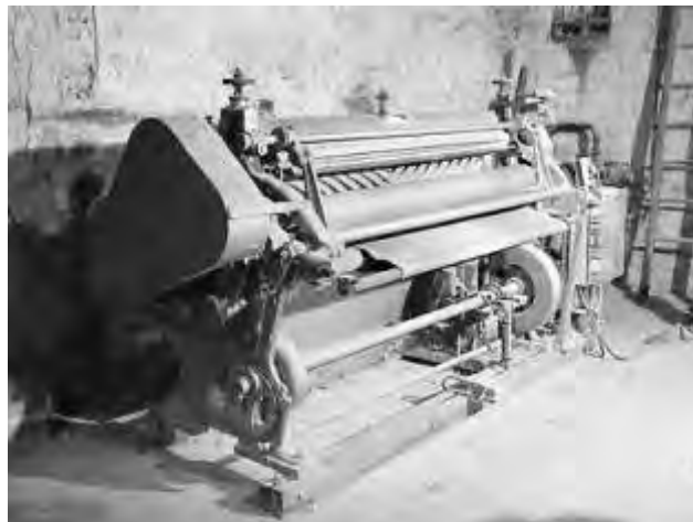
Metteuse au vent, qui essore et étire la peau
