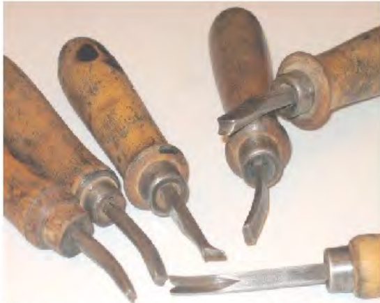
Chaque gouge donne un profil différent à la semelle
